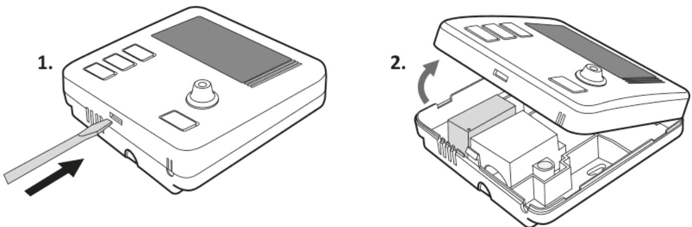
Kabelové svorky jsou umístěny na zadním stěně AURATON Cetus, **pod plastovým krytem**.
