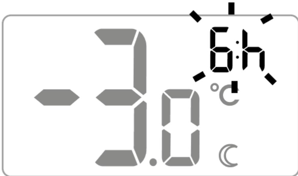
3. Pole hodin na displeji se přepne do režimu úprav a začne blikat. Opět pomocí knoflíku nastavíme počet hodin, po které má platit námi naprogramovaná snížená teplota. Můžete si vybrat od 1 do 12 hodin. Výběr potvrďte tlačítkem **OK**.
