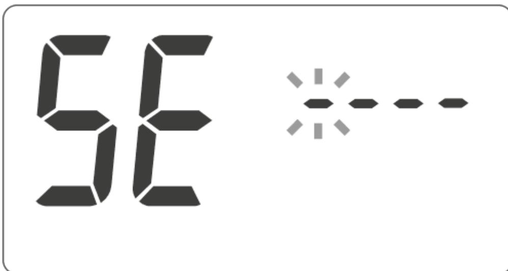
Wählen Sie mit dem Drehknopf +/- den eingestellten Code und drücken Sie nach jeder Ziffer (innerhalb von 10 Sekunden)
