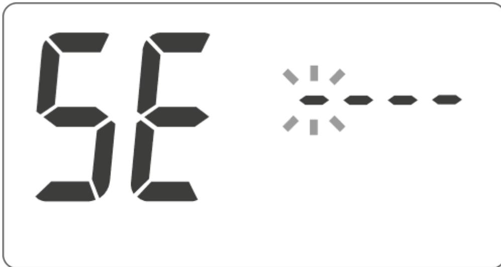
Wenn Sie den Wert von 0 bis 9 (innerhalb von 10 Sekunden) mit dem Drehregler +/- ändern, drücken Sie innerhalb der nächsten 10 Sekunden **OK**. Wenn Sie dies nicht tun, verlässt AURATON Libra H diesen Modus (Normalbetrieb) und der Einstellvorgang muss neu gestartet werden.
