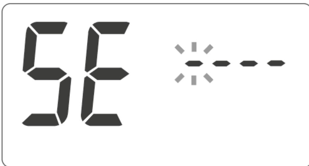
Wenn Sie den Wert von 0 bis 9 (innerhalb von 10 Sekunden) mit dem Drehregler +/- ändern, drücken Sie innerhalb der nächsten 10 Sekunden **OK**. Wenn Sie dies nicht tun, verlässt AURATON Libra RH diesen Modus (Normalbetrieb) und der Einstellvorgang muss neu gestartet werden.
