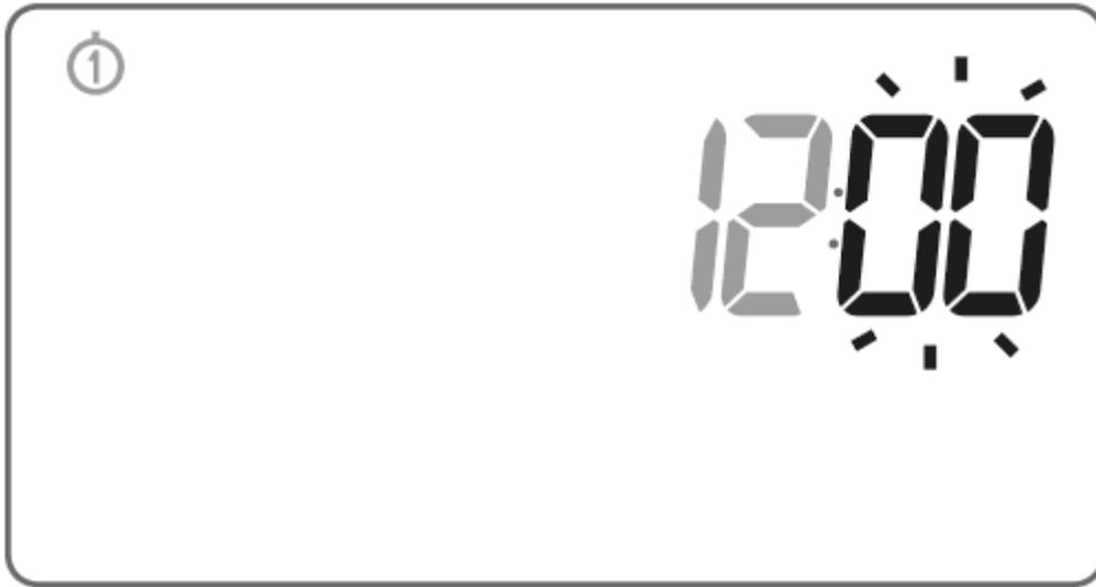
In der oberen linken Ecke wird ein blinkendes Wochentagssymbol angezeigt. Drehen Sie den Drehknopf nach links oder rechts, um den gewünschten Tag einzustellen und bestätigen Sie die Auswahl mit **OK**.
