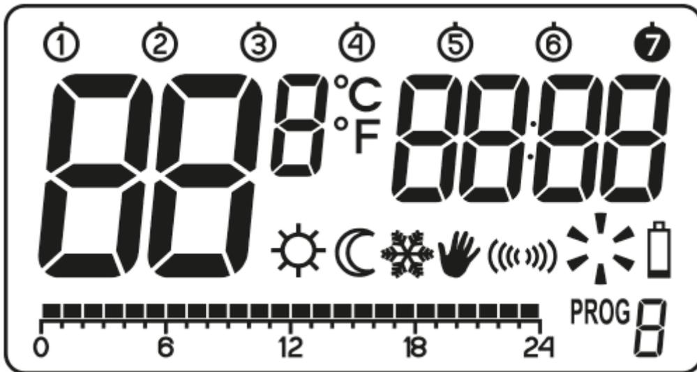
Nach einer Weile wechselt AURATON Libra R automatisch zur Zeiteinstellung. Ein blinkendes Element auf dem Bildschirm bedeutet, dass sich das Gerät derzeit im Bearbeitungsmodus befindet. Drehen Sie den Drehknopf nach links oder rechts, um die gewünschte Stunde einzustellen und bestätigen Sie mit
