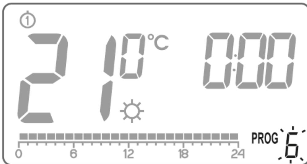
Alle (24) schwarzen Rechtecke werden auf der Zeitleiste beleuchtet, von denen jedes 1 Stunde darstellt. Ein sichtbares Rechteck bedeutet, dass die Tagestemperatur zu diesem Zeitpunkt gehalten werden soll. Das Fehlen eines Rechtecks über der Zeitleiste ist gleichbedeutend mit der Planung der Nachttemperatur.
