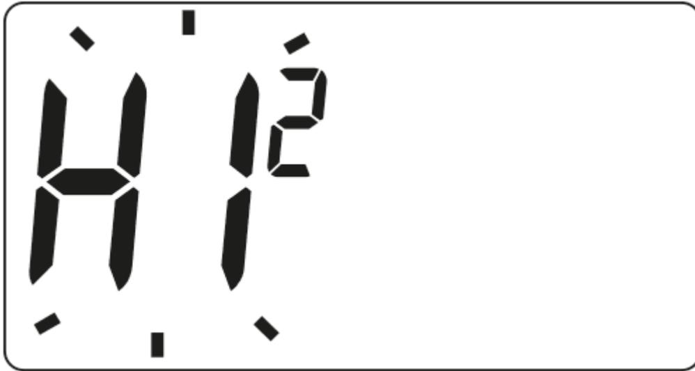
Der Hysterese-Wechselmodus wird durch den blinkenden Text HI signalisiert. Drehen Sie den Drehknopf nach links oder rechts, um die gewünschte Hysterese einzustellen.
