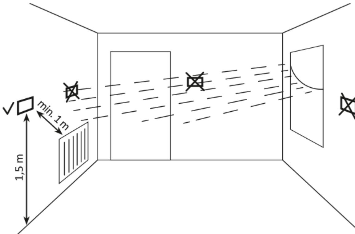
Der ordnungsgemäße Betrieb von AURATON Libra R wird maßgeblich durch seinen Standort beeinflusst. Wenn das Gerät an einem Ort ohne Luftzirkulation oder in direktem Sonnenlicht steht,
