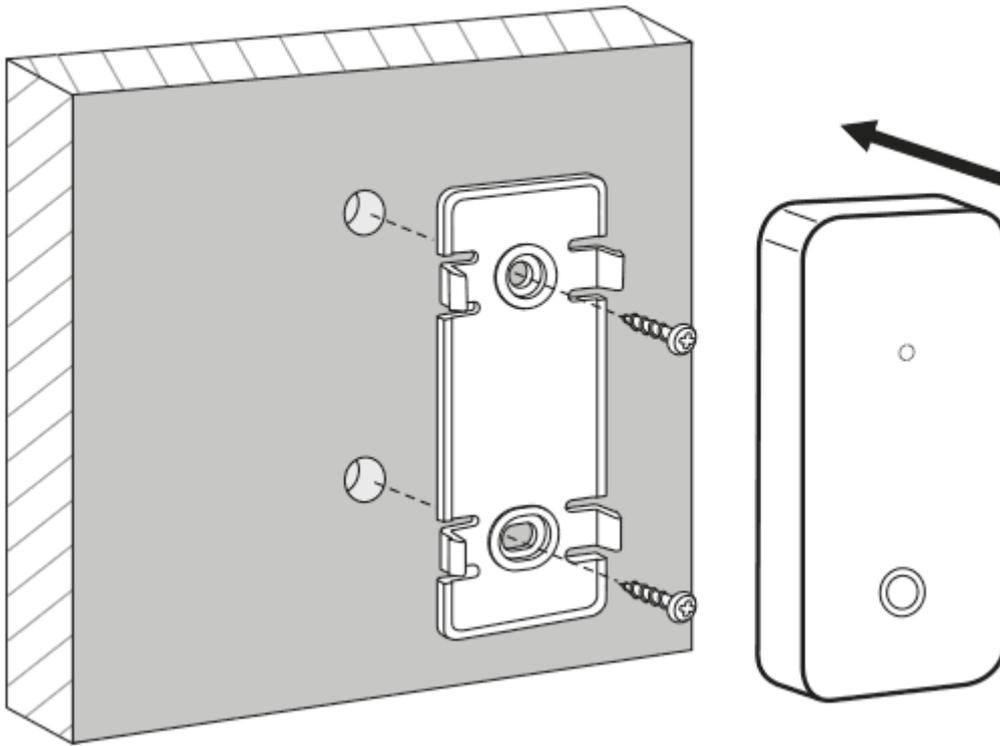
1. Bohren Sie zwei Löcher mit einem Durchmesser von 5 mm in die Wand (der Abstand der Löcher sollte mit dem mitgelieferten Montagewinkel gemessen werden).
