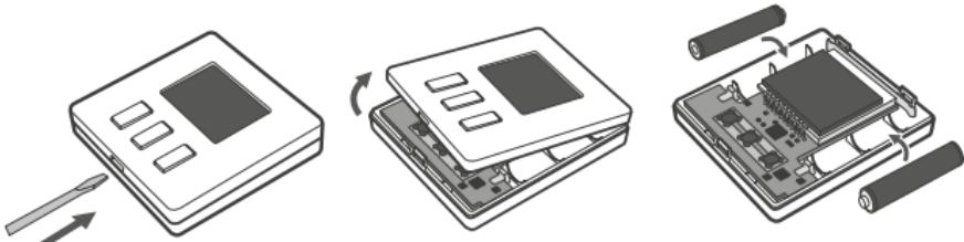
Vložte dvě baterie AAA 1,5 V do prostoru pro baterie a věnujte pozornost správné polarizaci baterií. Po skončení výměny baterií sejměte kryt hlavice připárováné k tomuto termostatu **AURATON 200 TRA** na dobu 5 vteřin a poté kryt znova nasaďte.
