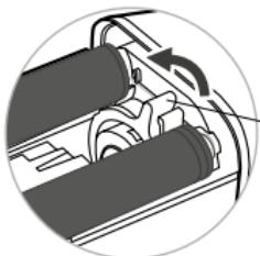
**f)** Otočte pojistný kroužek do polohy „zajištěný“.
