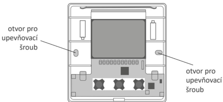
3. Vložte do vyvrstaných otvorů hmoždinky.
