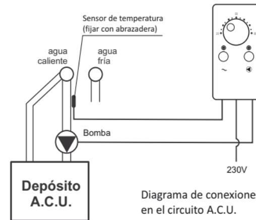
Esquema de conexiones con el reservatorio A.C.U.
