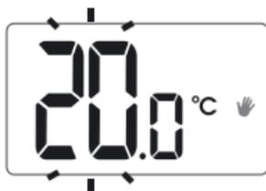
2. Al girar el selector a la izquierda o a la derecha, se ajusta el valor de temperatura deseado. Se confirma con el botón
