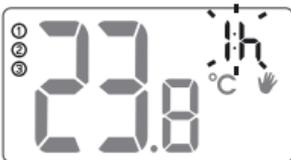
**NOTA:** El modo manual no se repite automáticamente. Una vez transcurrido el tiempo programado, el regulador vuelve a la realización de los programas de temperatura anteriores: modo normal y de reducción temporal, siempre que éste segundo se hubiera programado anteriormente.
