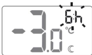
3. El campo de horas en el display pasará al modo de edición y empezará a parpadear. Al girar el botón de nuevo, se ajusta el número de horas durante las cuales se aplicará el programa de temperatura reducida. Se puede seleccionar entre 1 a 12 horas. Se confirma la selección con el botón OK.
