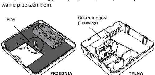
Podczas składania należy zadać by „piny” zostały umieszczone w „gniezdecie złącza pinowego”.
