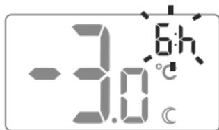
3. Il campo sul display passerà in modalità di modifica e inizierà a lampeggiare. Utilizzando nuovamente la manopola, impostiamo il numero d'ore per la durata della temperatura ridotta da noi impostata. Esiste la possibilità di selezione da 1 a 12 ore. La selezione va confermata con il pulsante
