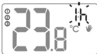
**ATTENZIONE:** La modalità manuale non viene ripetuta automaticamente. Dopo il superamento del tempo programmato, il regolatore torna alla realizzazione dei programmi di temperatura precedenti: modalità normale e di riduzione temporanea della temperatura, se la seconda è stata previamente programmata.
