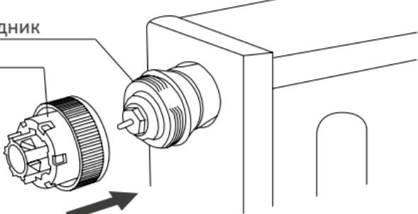
**в)** Выполнить действия начиная с пункта **б)** и до **з)** раздела „Способ установки головки TRA на радиатор со вставкой M30x1,5”
