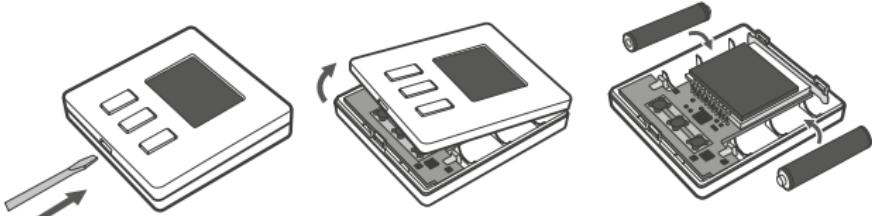
Вставить две батарейки AAA 1,5 V в батарейные отсеки, контролируя правильное расположение полюсов батареек. Затем, для улучшения работы, необходимо снять крышку аккумулятора связанных головок с AURATON 200 TRA на 5 сек., и после этого установить обратно.
