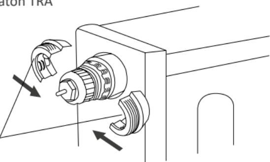
**б)** На составной переходник В навинтить до упора адаптер А
