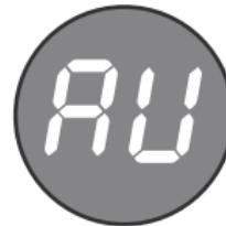
На дисплее отобразится надпись „AU“ (автоматическая работа).
