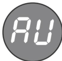
Установка значения „AU” означает, что контроллер снова будет работать в автоматическом режиме (привод с концевыми выключателями).
