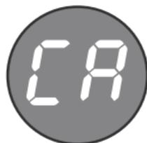
После завершения процесса калибровки на дисплее отображается текущая температура датчика. Контроллер готов к установке соответствующей рабочей температуры.
