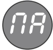
**УПРИМЕЧАНИЕ:** В случае кратковременного сбоя питания активируется функция АВТОКАЛИБРОВКИ, и когда калибровка будет завершена, контроллер вернется к нормальной работе. На дисплее последовательно отображается информация: тест дисплея, версия программного обеспечения (напр. F1.2), надпись „AU” (время автоматической работы контроллера) или „NA” (время работы контроллера, установленное вручную), затем отобразится надпись „CA”, информирующая о включенной функции калибровки.
