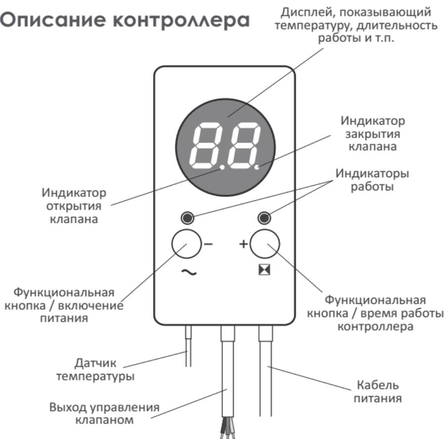
*Индикаторы открытия и закрытия клапана используются для иллюстрации работы привода. Мигающие индикаторы указывают на работу клапана влево или вправо.*
