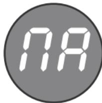
**УПРИМЕЧАНИЕ:** В случае кратковременного сбоя питания активируется функция АВТОКАЛИБРОВКИ, и когда калибровка будет завершена, контроллер вернется к нормальной работе. На дисплее последовательно отображается информация: тест дисплея, версия программного обеспечения (напр. F1.2), надпись „AU” (время автоматической работы контроллера) или „NA” (время работы контроллера, установленное вручную), затем отобразится надпись „CA”, информирующая о включенной функции калибровки.
