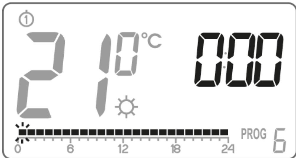
Cu ajutorul butonului selectați temperatura de zi (patratul este aprins) sau de noapte (dreptunghiul este stins). Apoi selectați intervalul de timp pentru temperatura respectivă cu ajutorul butonului rotativ.
