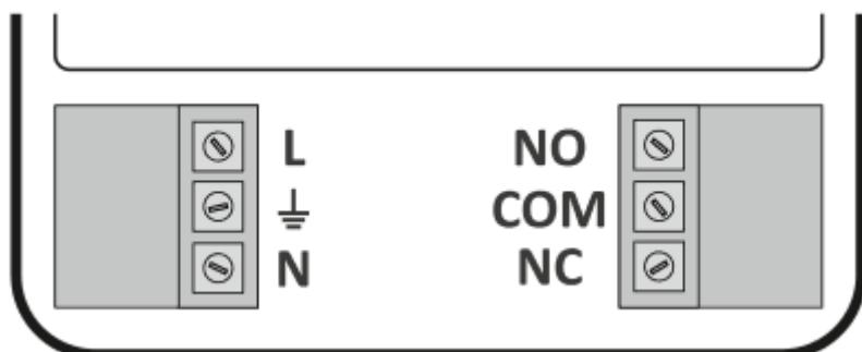
Conectați cablurile de alimentare la clemele conectorului sursei de alimentare a receptorului
