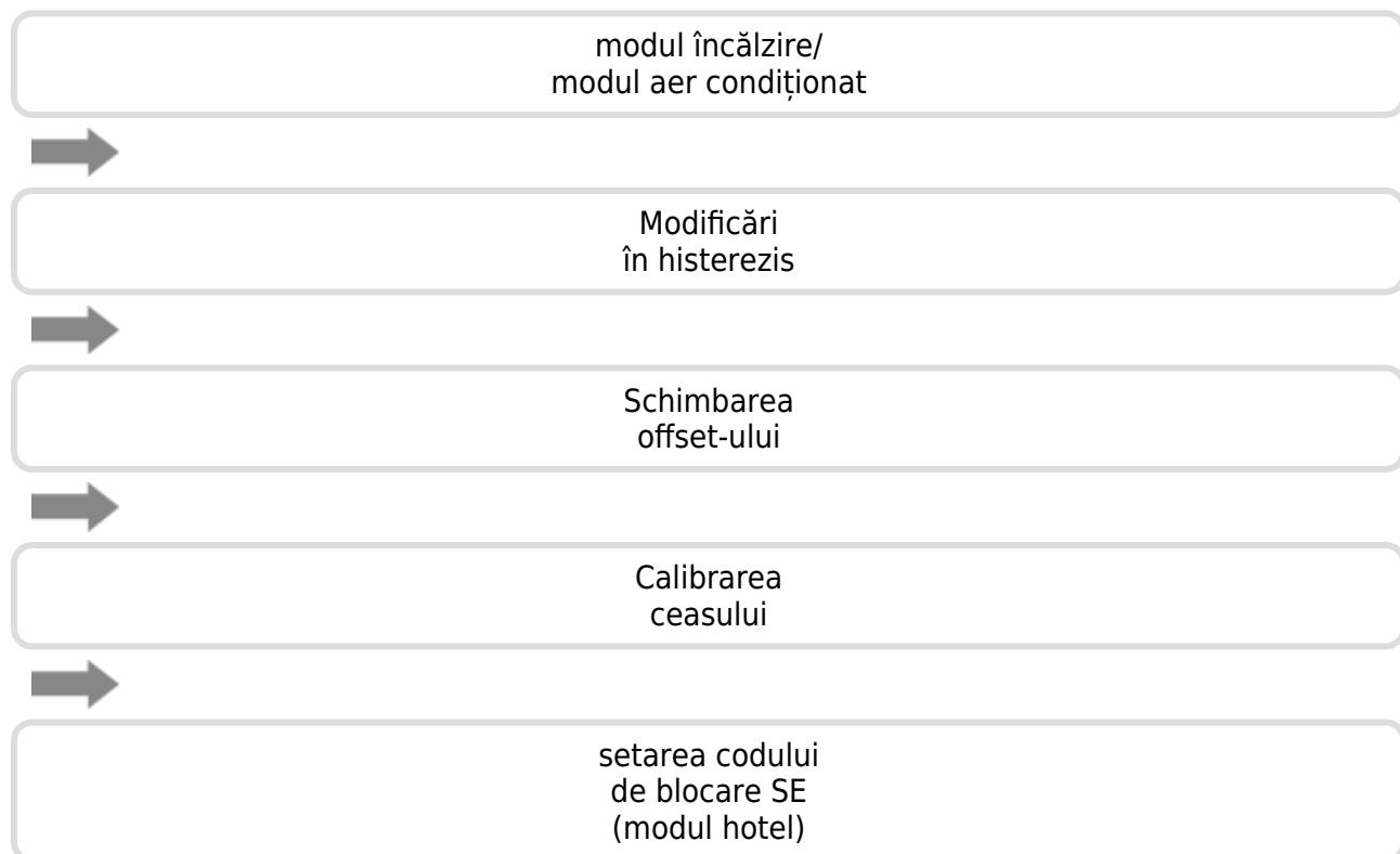
Pentru a intra în modul de editare a setărilor de configurare, apăsați și țineți simultan butoanele **PROG** și **OK** timp de 3 secunde până când apare afișat meniul de setări.
