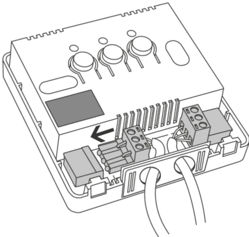
Conectați dispozitivul de încălzire sau climatizare la clemele conectorului de comandă a AURATON Fornax. Urmați instrucțiunile de service pentru dispozitivul de încălzire sau climatizare. Clemele cele mai utilizate sunt COM (comun) și NO (circuit normal deschis).
