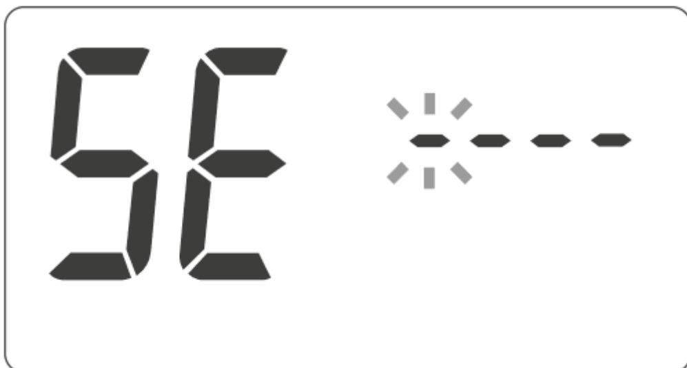
În schimb, dacă cu butonul +/- (în decurs de 10 secunde) se va modifica valoarea de la 0 la 9, atunci în următoarele 10 secunde apăsați tasta **OK**. Dacă acest lucru nu se face, AURATON Libra H va ieși din acest mod (funcționare normală) și procedura de setare va trebui reluată. În schimb, dacă după setarea primei cifre, apăsați tasta **OK** în decurs de 10 secunde, termostatul va trece la editarea următoarei cifre (cea de-a doua).
