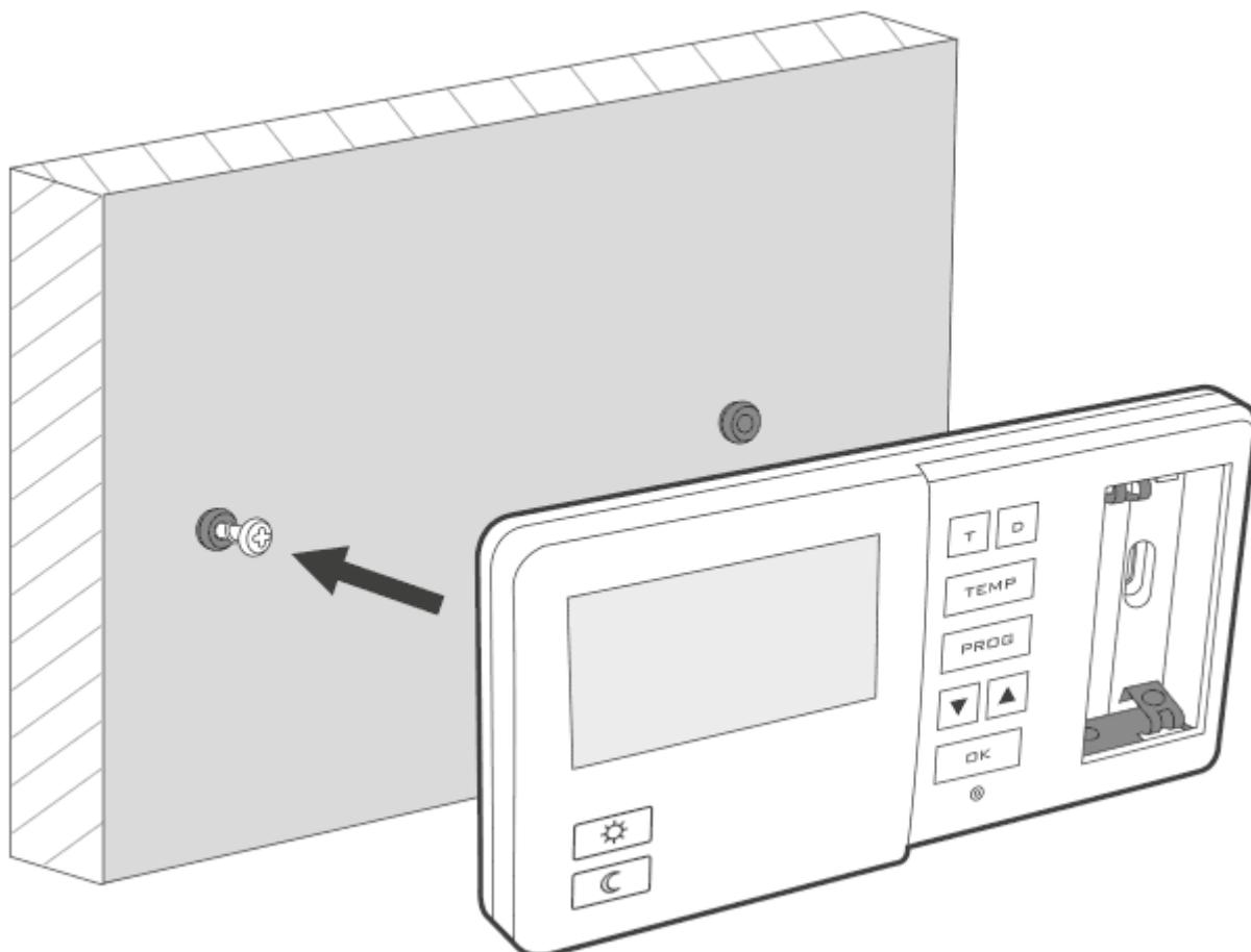
5. Înșurubați șurubul drept, astfel încât să țină ferm AURATON Pavo montat.
