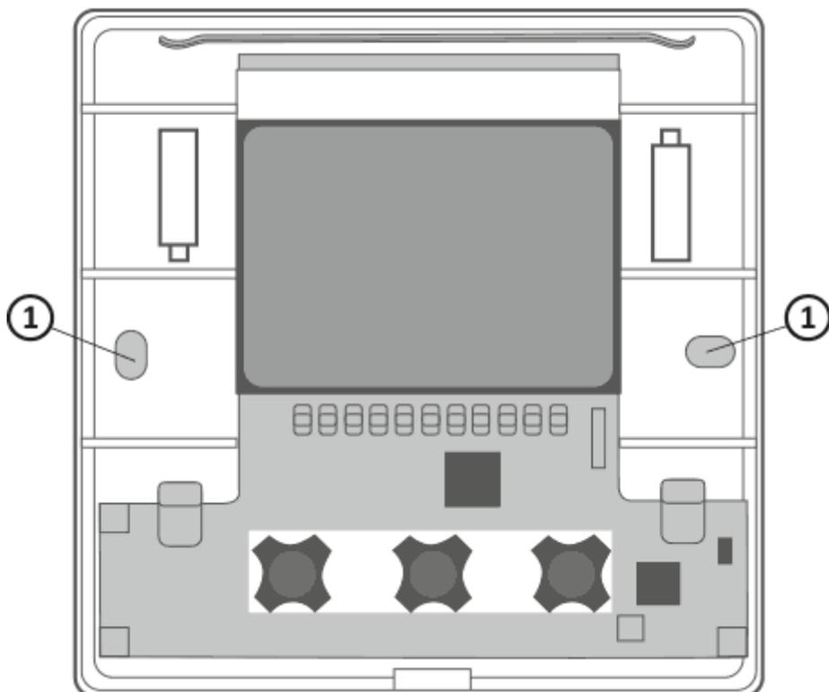
1. Отверстия для крепежных винтов.
