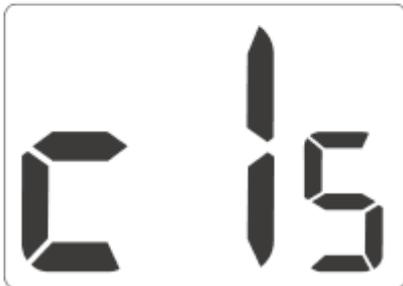
После правильной установки батарей в гнезда на ЖК-дисплее, на 1 секунду отобразятся все сегменты (тест дисплея), после чего следует номер версии программного обеспечения. Через некоторое время отобразится текущая температура. AURATON Arus R готов к работе.
