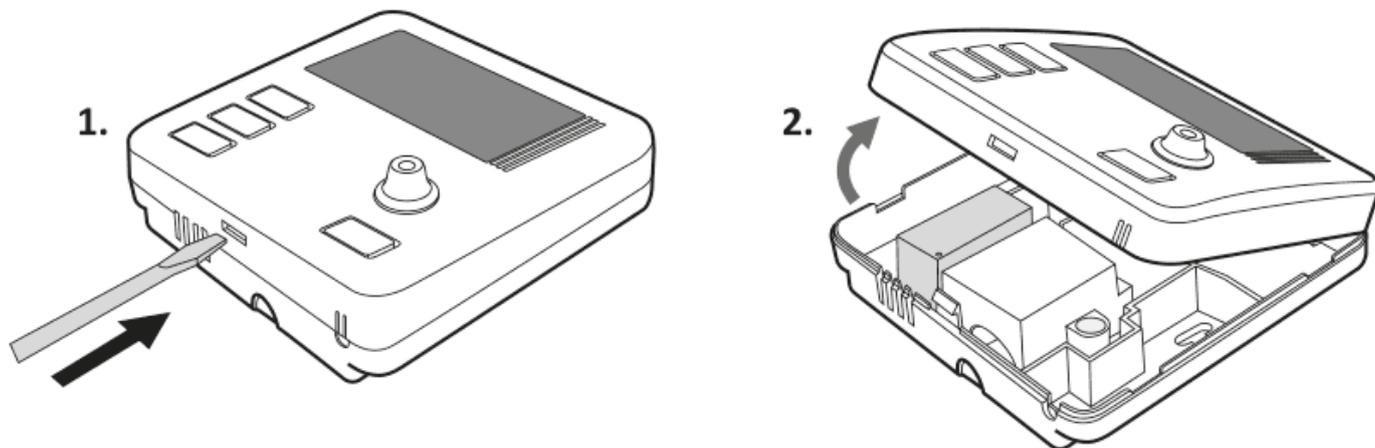
Клеммы проводов расположены на задней стенке AURATON Cetus P, **под пластиковой крышкой.**
