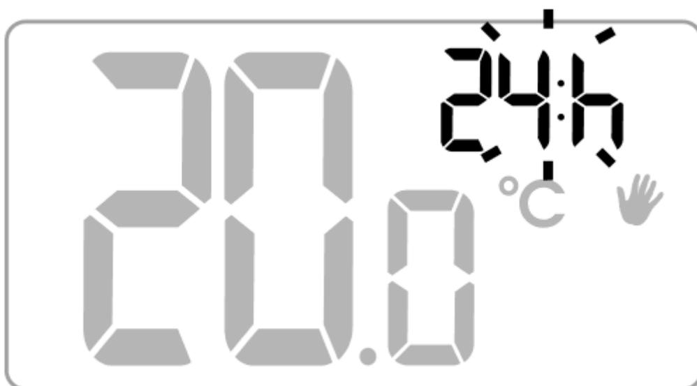
3. Поле часов на дисплее перейдет в режим редактирования и начнет мигать. Ручку можно использовать для выбора количества часов, в течение которых должна применяться ручная настройка температуры. Дни добавляются или вычитаются автоматически, когда значение превышает 24 часа. Можно выбрать максимум 7 дней и 24 часа. Выбор должен быть подтвержден кнопкой **OK**.
