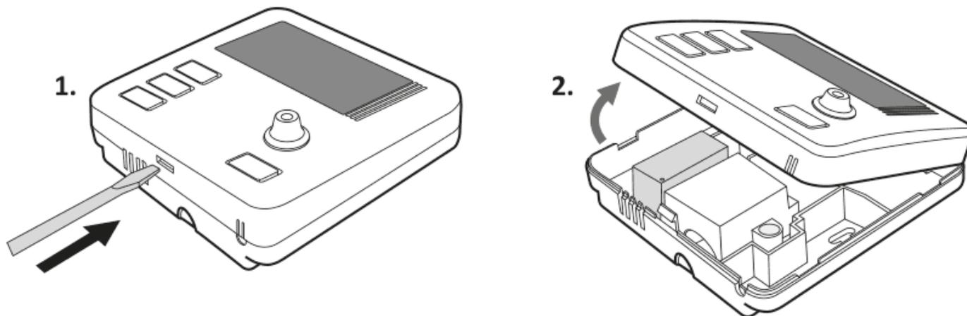
Клеммы проводов расположены на задней стенке AURATON Cetus, **под пластиковой крышкой.**
