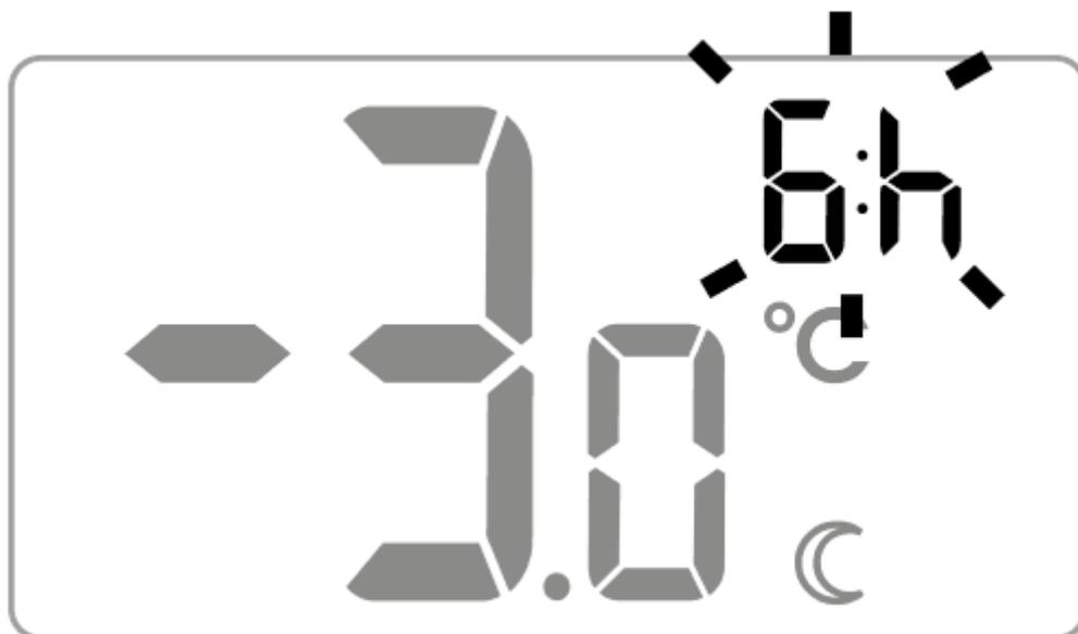
3. Поле часов на дисплее перейдет в режим редактирования и начнет мигать. Снова используя ручку, мы устанавливаем количество часов, в течение которых должна применяться запрограммированная нами пониженная температура. Можно выбрать от 1 до 12 часов. Выбор подтвердите нажатием
