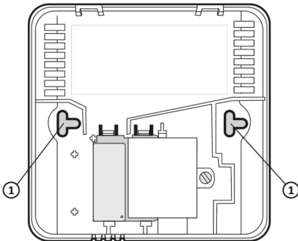
1. отверстие под крепящий винт
