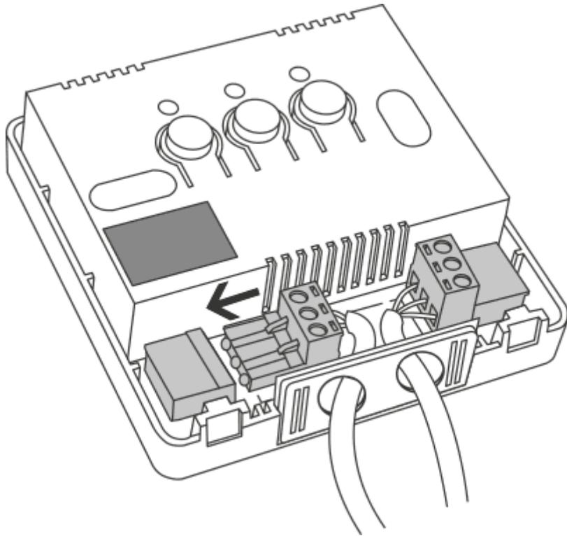
Подключите устройство отопления или кондиционирования воздуха к клеммам разъема управления AURATON Fornax. Следуйте руководству по обслуживанию устройства отопления или кондиционирования воздуха. Наиболее часто используемыми клеммами являются COM (общая) и NO (нормально разомкнутая цепь).
