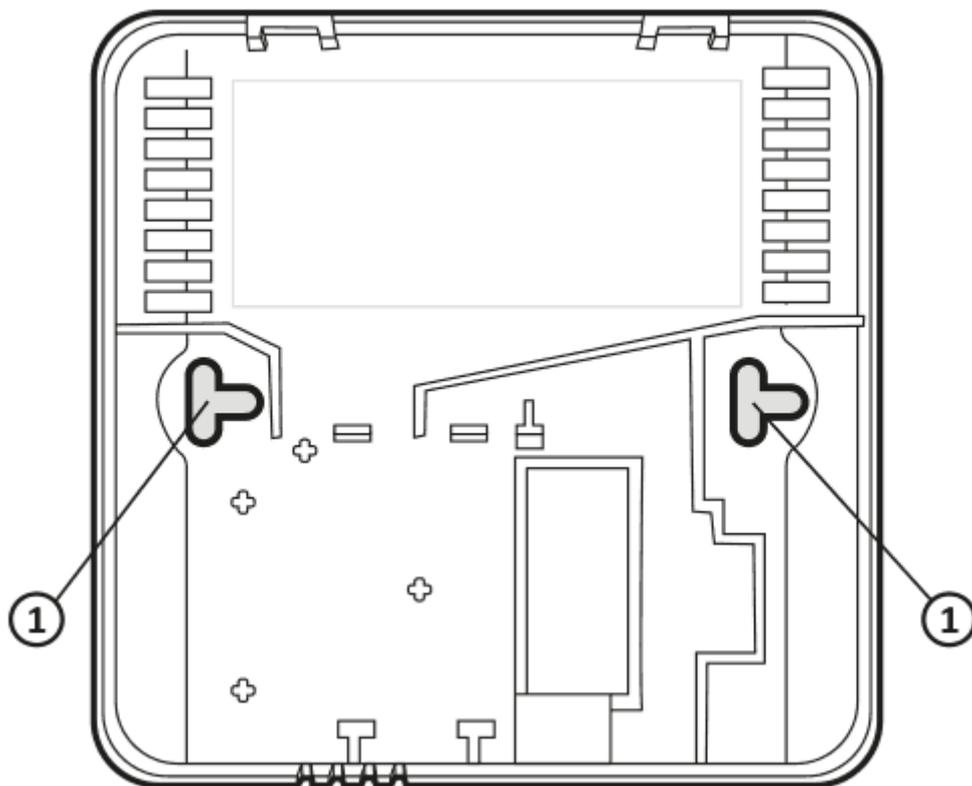
1. отверстие для крепления винта
