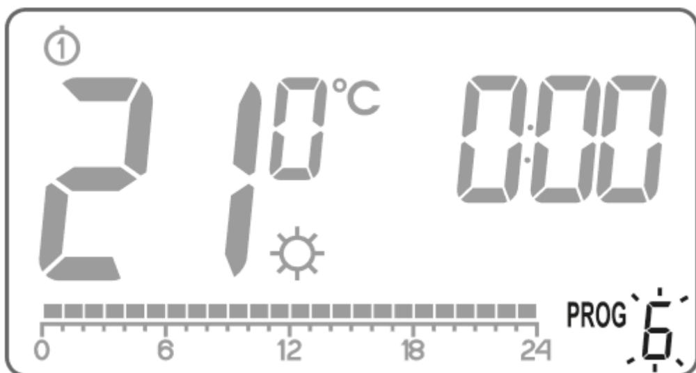
На линии времени будут отображены все (24) черных прямоугольника. 1 прямоугольник соответствует 1 часу. Если прямоугольник виден, это означает, что в течение данного часа будет установлена комфортная температура. Отсутствие прямоугольника означает установку пониженной температуры.
