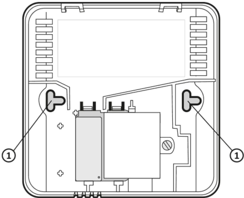
1. отверстие для крепления винта
