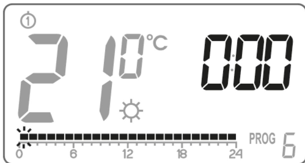
Кнопкой выбрать комфортную температуру (установленный прямоугольник) либо пониженную температуру (прямоугольник отсутствует) на линии времени.
