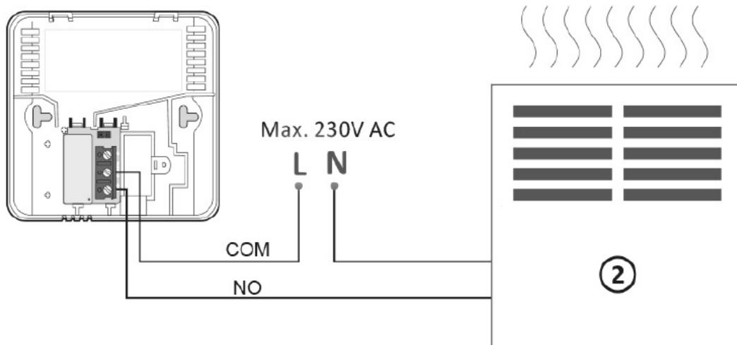
1. Нагревательное устройство, например: газовый котел
