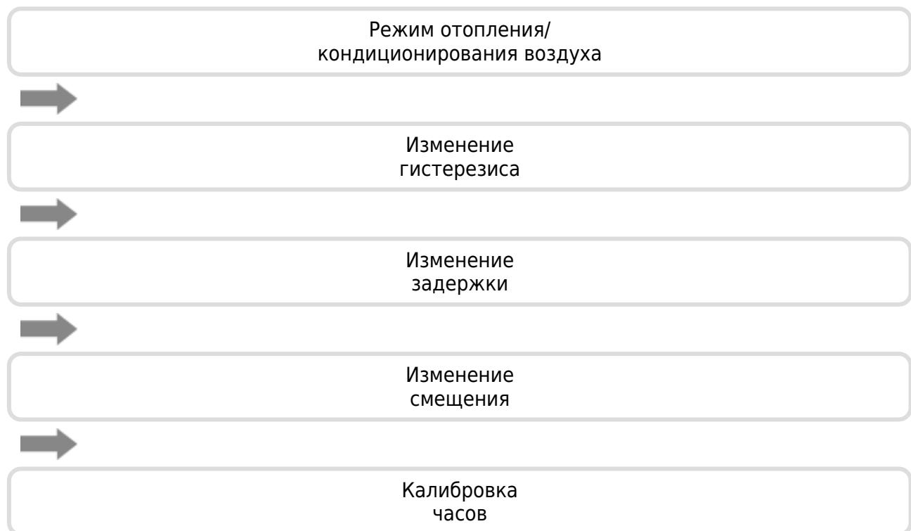
Для входа в режим редактирования параметров конфигурации удерживайте одновременно кнопки **PROG** и **OK** в течение 3 секунд, пока не отобразится меню настроек.
