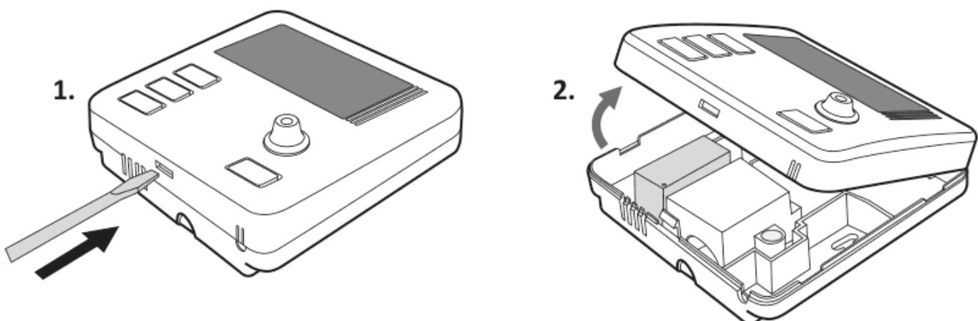
Клеммы расположены на задней панели AURATON Libra, **под пластиковым корпусом**.
