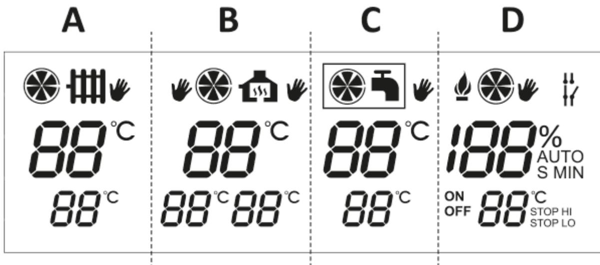
Дисплей контроллера AURATON Ursa разделён на 4 части. Каждая из них отвечает за управление отдельным устройством:
