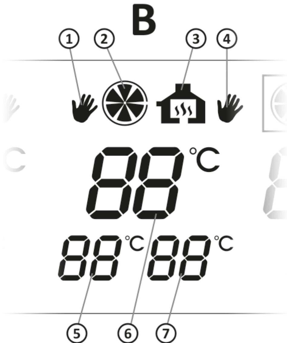
1. Индикатор ручного включения насоса центрального отопления.
